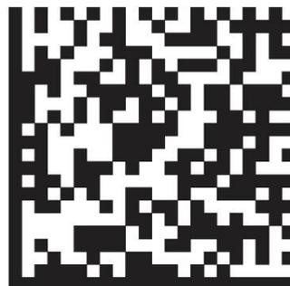
Figura 3 - Esempio di codice bidimensionale DataMatrix
